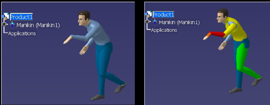
نتیجه تحلیل RULA نشان داده شده با کدهای رنگی بر روی اعضای مدل بدن
